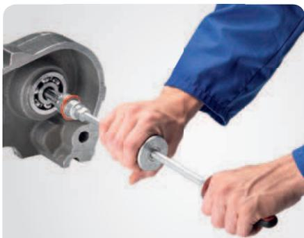
滑动锤允许施加高冲击力，采用符合人体工程学的设计，以提高用户安全性。
