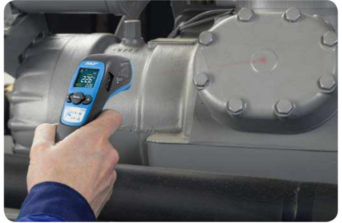
使用非接触测量模式时，测温仪通过热敏传感器检测从目标物体辐射出来的热能。将红外测温仪指向目标物体，热敏传感器收集能量，转换成信号，经微处理芯片的处理显示在有背光的显示屏上。扣住扳机，热敏传感器会连续地测量目标物体的温度，这样就可以快速获得精确的实时读数。
